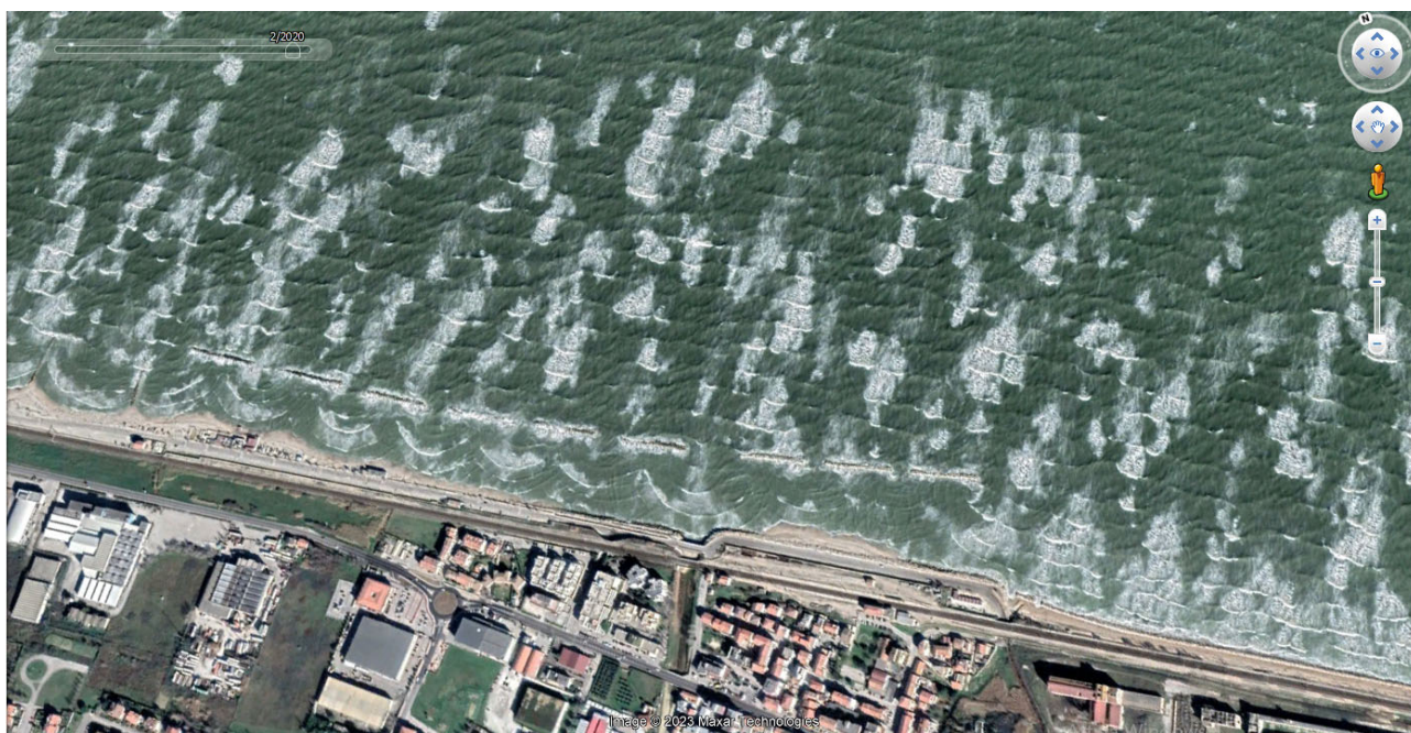
Figura 23 - Diffrazione ed overtopping in presenza di scogliere emerse durante una mareggiata
