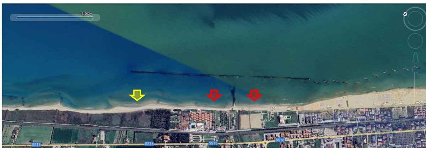
Figura 28 – Mappe satellitari (GoogleEarth) dal 2004 al 2024 – le frecce in rosso indicano le zone di erosione mentre la freccia gialla una zona di accumulo
