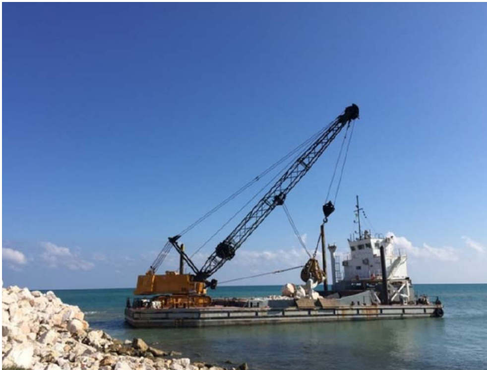
Figura 18 - Motopontone per carico, trasporto e posa scogli
