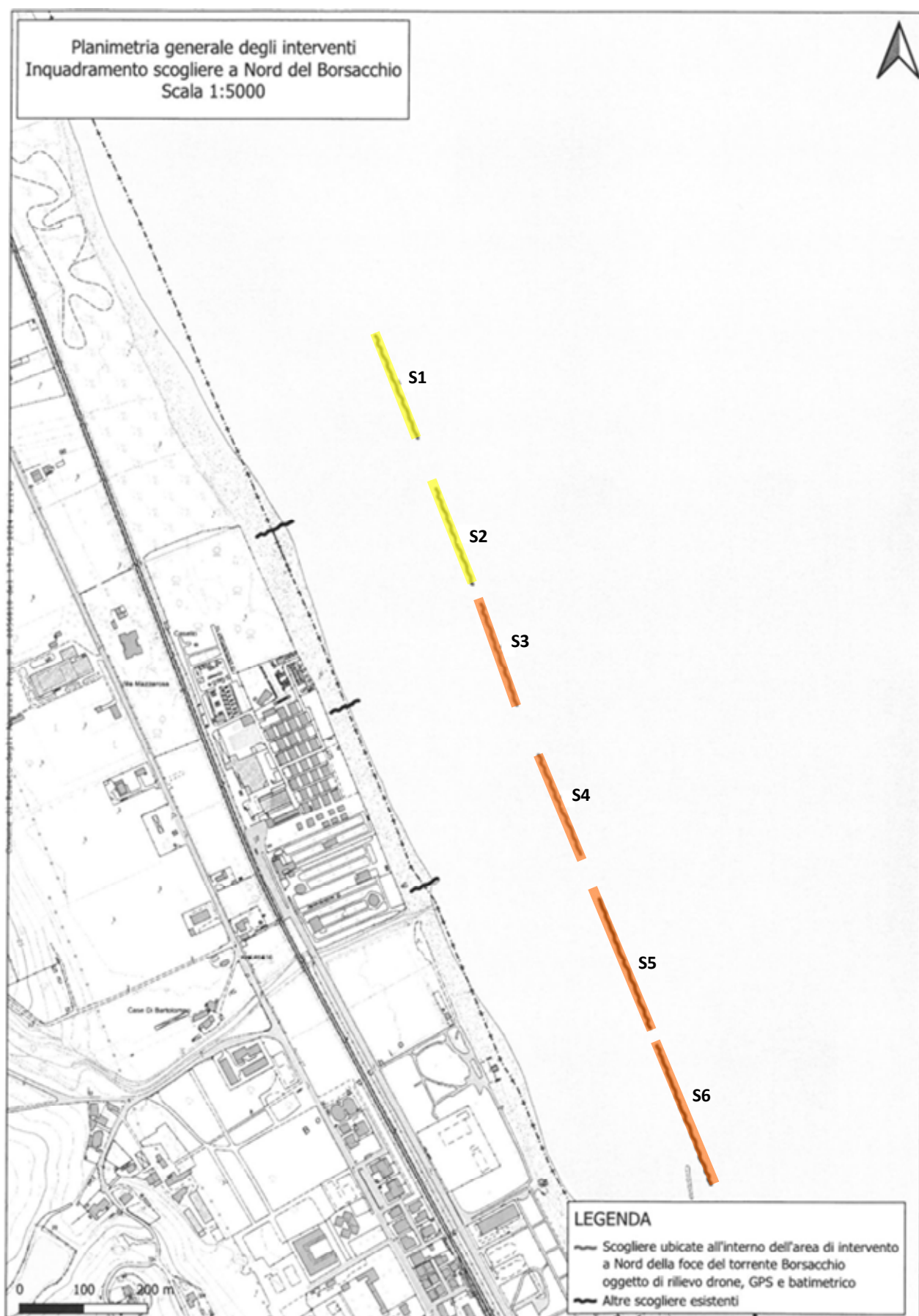
Figura 6 – Planimetria di progetto (in rosso sono evidenziate le trasformazioni da strutture sommerse a emerse, in giallo le strutture sommerse in cui vengono effettuati solo lavori di manutenzione)
